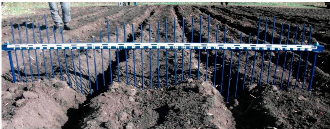
Рисунок 3. Определение микро рельефа створа профилометра
