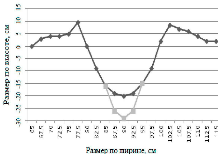
1 – рыхлая почва на дне борозды; 2 – основной фон почвы; 3 – открытая борозда; 4- холмик Рисунок 5. Профиль посадочной борозды
