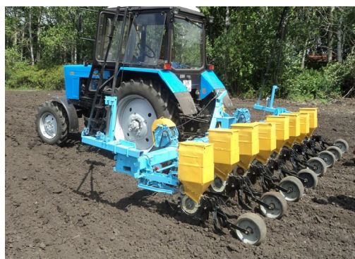
Рисунок 1. Модернизированная сеялка для высева капсулированных семян
