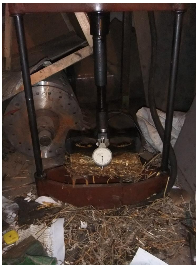
Рисунок 7. Процесс определения прочности лабораторных образцов
