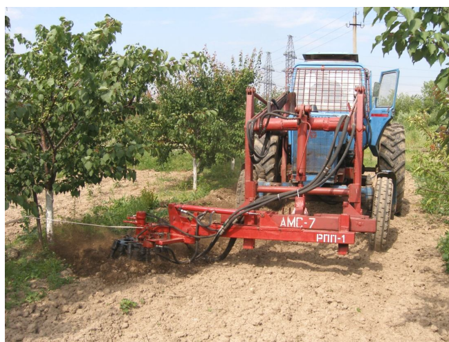
Рисунок 3. Агрегат для возделывания садов АМС-7 в компоновке с рабочим органом РПП-1 в работе
