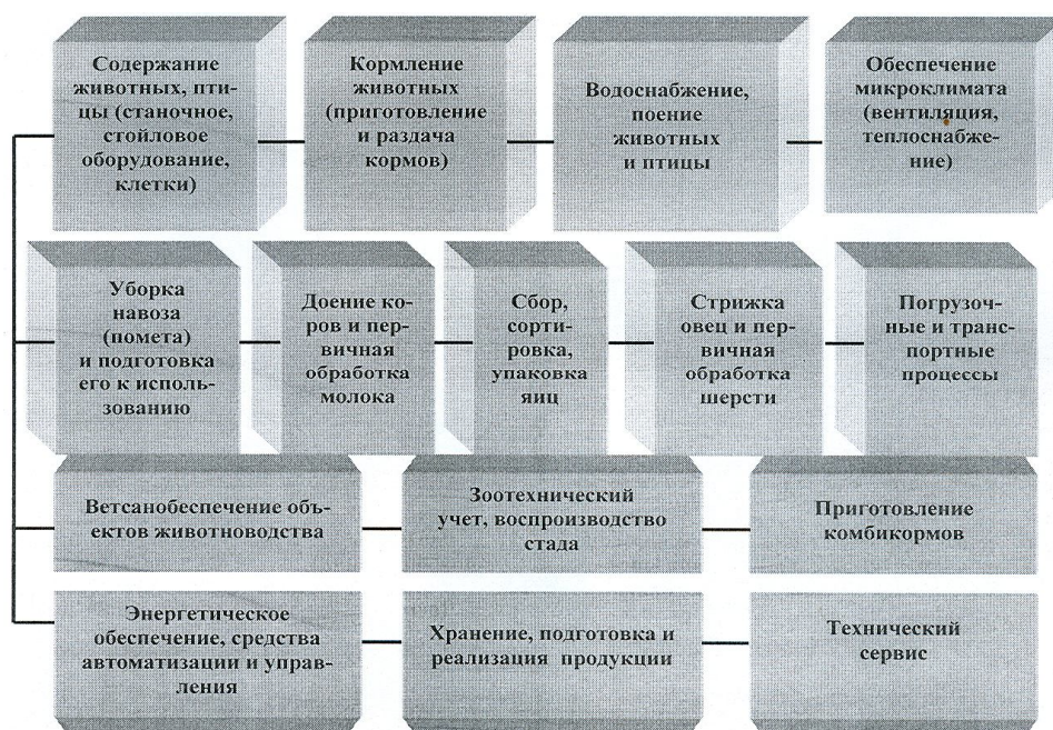
Рисунок 1. Структура технологических процессов при производстве продукции животноводства
