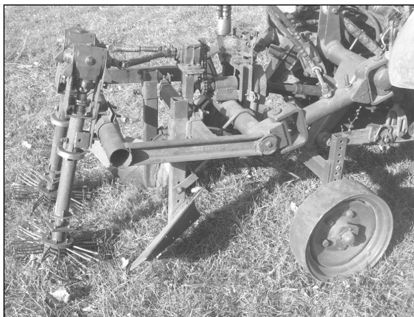
Рисунок 1 – Опытный образец машины для раскрытия корневой системы вегетативно размножаемых подвоев яблони.
