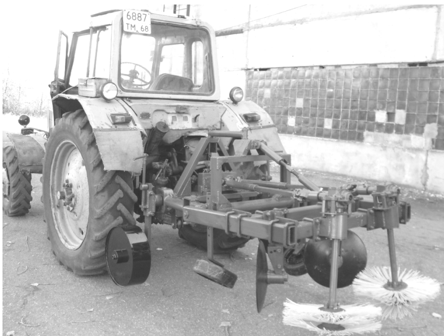
Рисунок 5 – Производственный образец машины для раскрытия корневой системы вегетативно размножаемых подвоев яблони.
