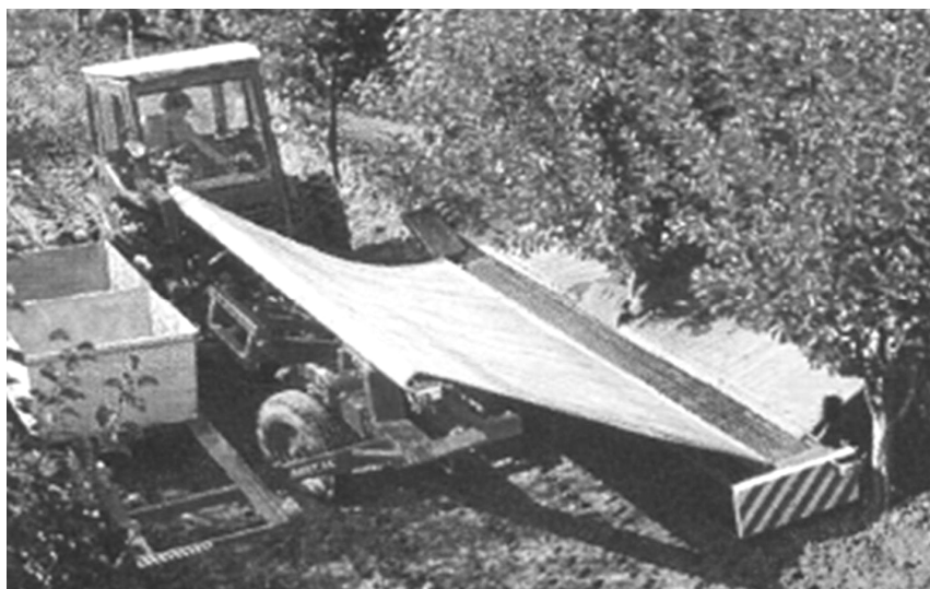
Рис. 2 Плодоуборочный комбайн МПУ-1А.
