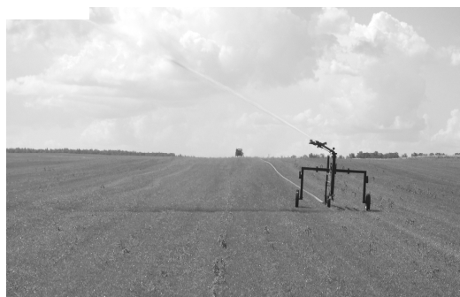
Рис. 4. Шланговые дождеватели барабанного типа: а - установка; б – дождевальный аппарат
