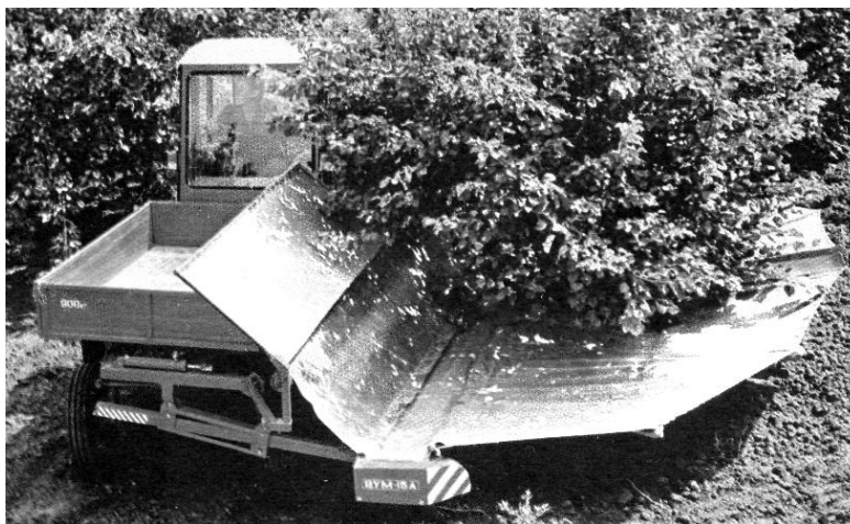
Рис. 3 Машина для уборки косточковых ВУМ-15А.
