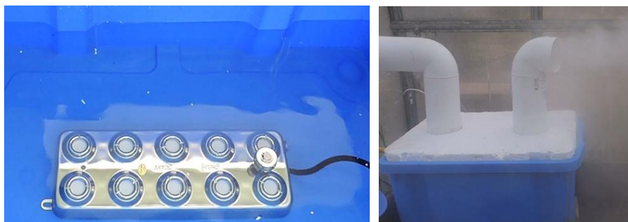
Рисунок 5. Головка ультразвукового увлажнителя – основной элемент системы (слева) и работающий увлажнитель (справа)
