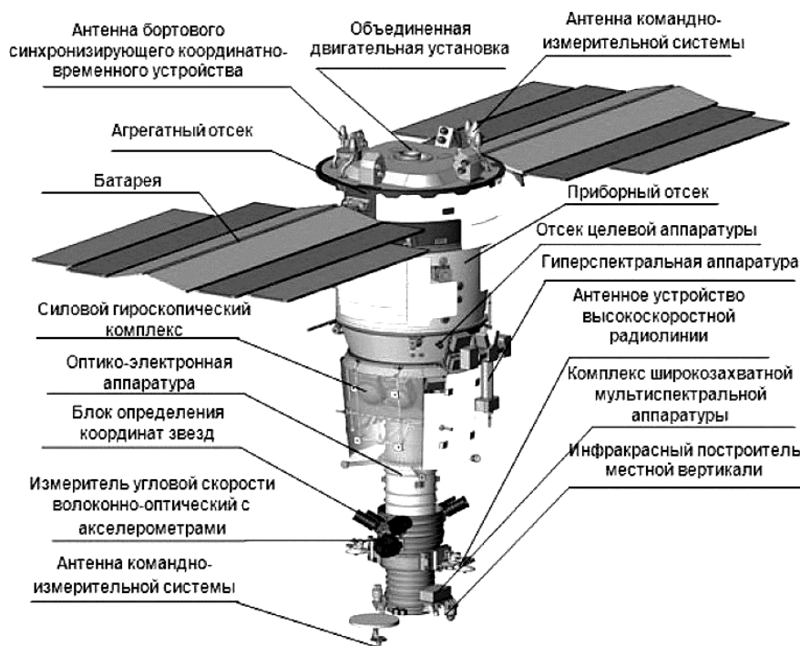
Рисунок 1. Схематический вид отечественного космического аппарата «Ресурс П», несущий аппаратуру гиперспектральной съемки поверхности Земли с высоты 475 км в диапазоне 0.4 – 1.1 мкм и разрешении 20 м [3].
