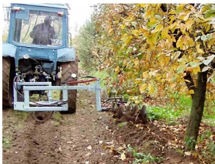
Рисунок 4. Полевые испытания дисковой секции
