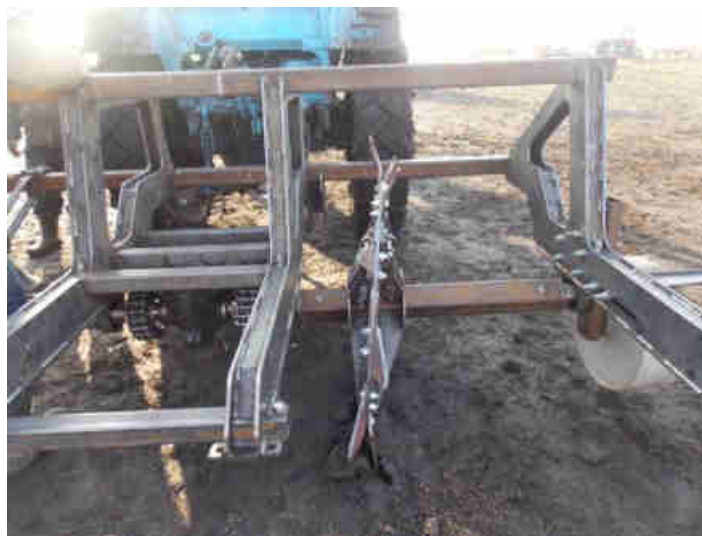
Рисунок 3. Макетный образец бороздонарезчика с рабочим органом по типу «качающаяся шайба»
