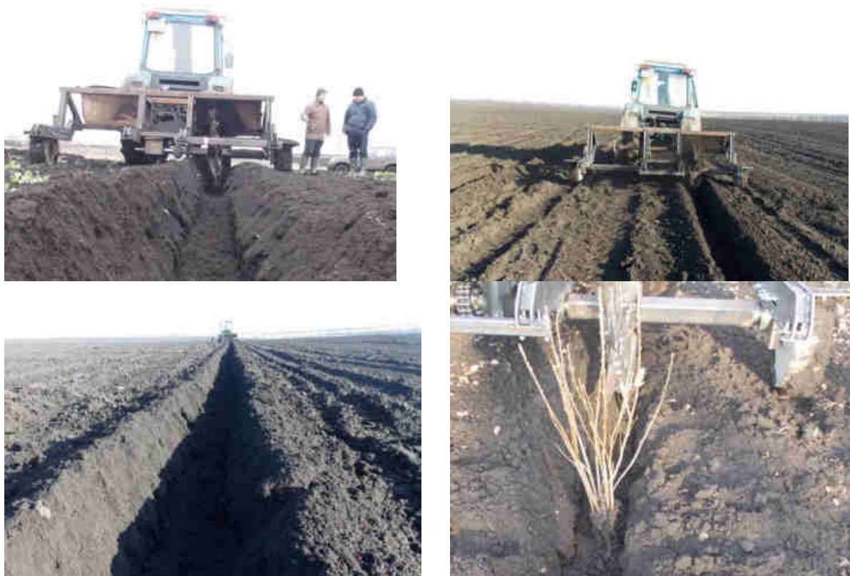
Рисунок 4. Фото-фрагменты предварительных испытаний нового бороздонарезчика
