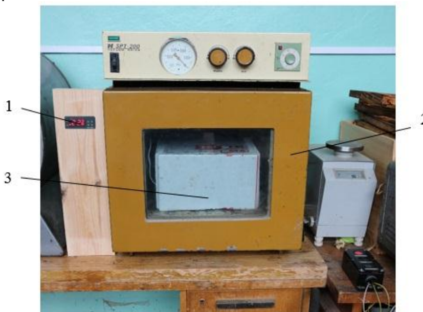
Рисунок 1. Лабораторная установка: 1 – блок управления; 2 – вакуумный сушильный шкаф; 3 – сушильная кассета.
