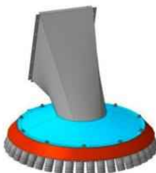
Рисунок 3. 3D-вид модели распределяющего устройства
