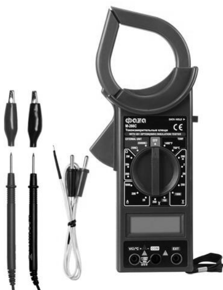
Рисунок 2. Прибор для исследования сопротивления подстилочного навоза (М-266С)
