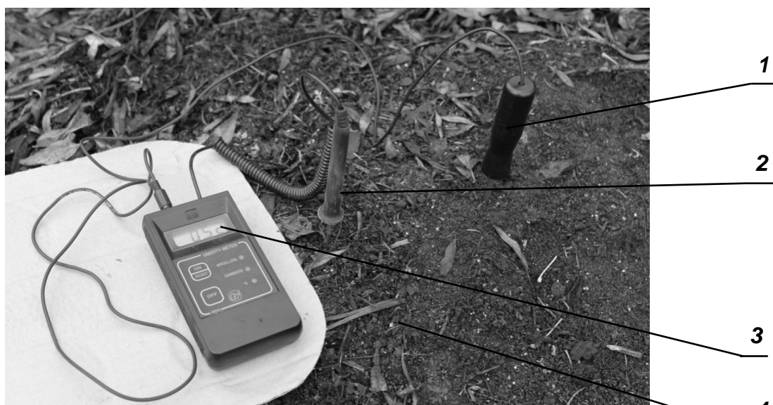
Рисунок 1. Измерение влажности и температуры подстилочного навоза влагомером 46908. 1 – зонд для измерения влажности; 2 – зонд для измерения температуры; 3 – регистрирующий прибор; 4 – бурт подстилочного навоза
