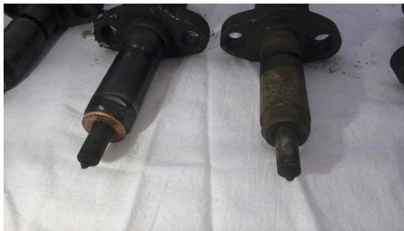
Рисунок 4.48 – Фото форсунок после работы дизельного двигателя на дизельном топливе (справа) и дизельном смесевом топливе (слева)
