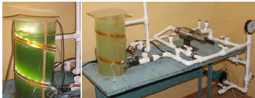
Рисунок 3.4 – Общий вид экспериментального закрытого циркулирующего трубчатого фотобиореактора для культивирования микроводорослей
