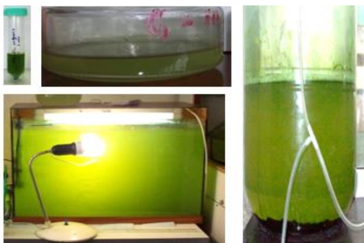
Рисунок 3.2 – Исходный штамм микроводоросли (слева), штамм микроводоросли в стеклянном сосуде (в центре вверху), в фотобиореакторе глубинного типа (в центре внизу), в фотобиореакторе трубчатого типа (справа)
