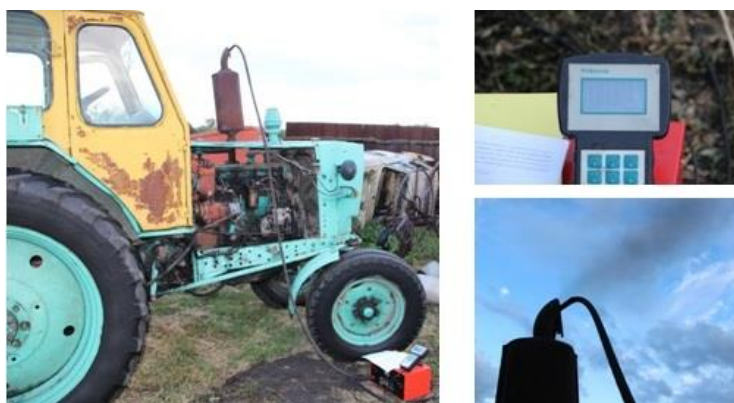
Рисунок 3.17 – Измерение дымности отработанных газов на тракторе ЮМЗ
