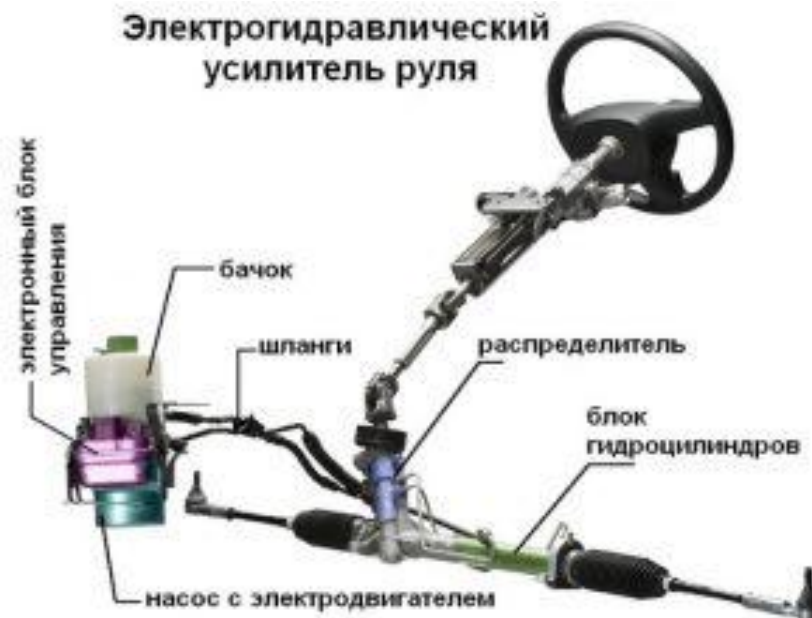
Рисунок 1 – Общий вид конструкции электрогидроусилителя руля
