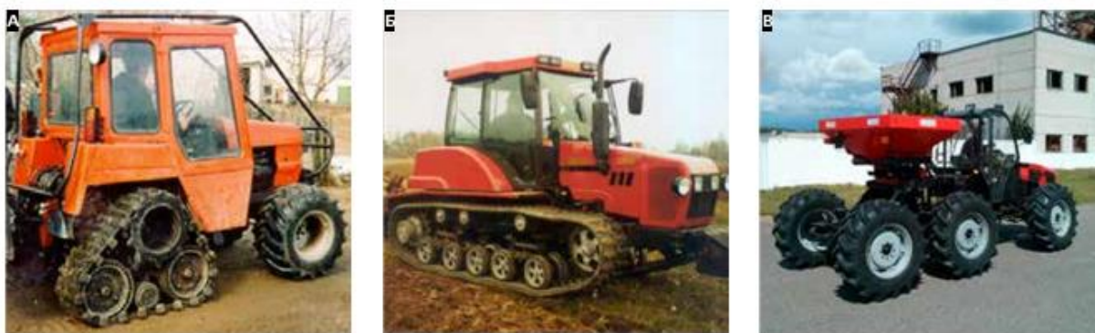
Рисунок 3 – Агроэкологические ходовые системы (текущие результаты): полугусеничная (А); гусеничная (Б), на шинах сверхнизкого давления (В)
