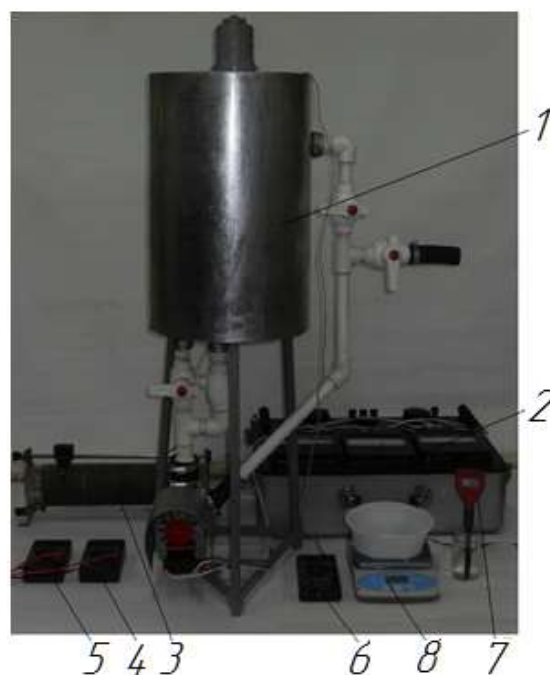
Рисунок 3.11 – Функциональная схема и общий вид (фото) лабораторной установки исследования процессов нагревания и нейтрализации СКЭ.
