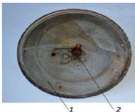
Рисунок 5.4 – Крышка мембранного насоса с лепестковым обратным клапаном.
