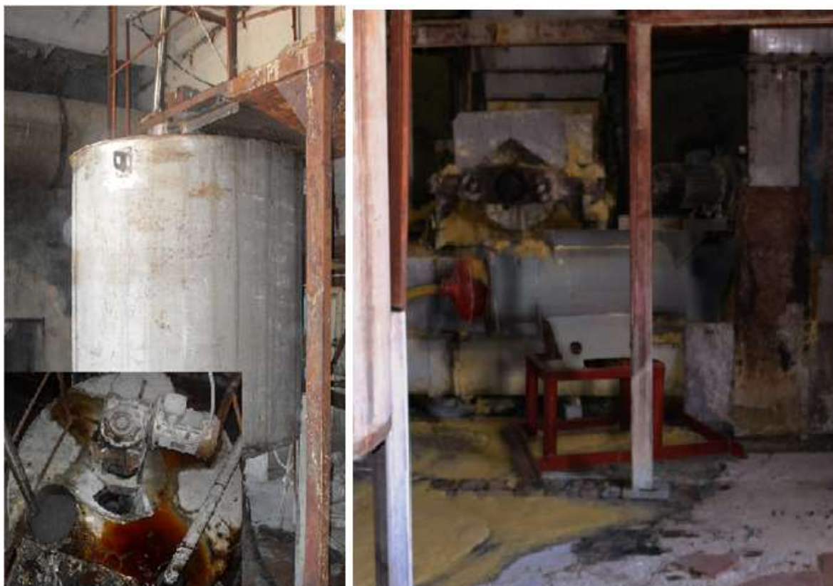
Рисунок 5.6 –Производственные образцы нейтрализатора СКЭ и шнеко-лопастного смесителя при испытании.
