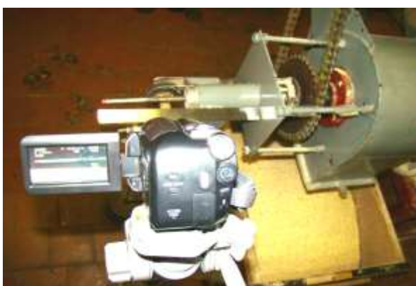
Рисунок 3.20 – Фиксация показателя амплитуды колебания рабочего органа шнеко-лопастного смесителя.
