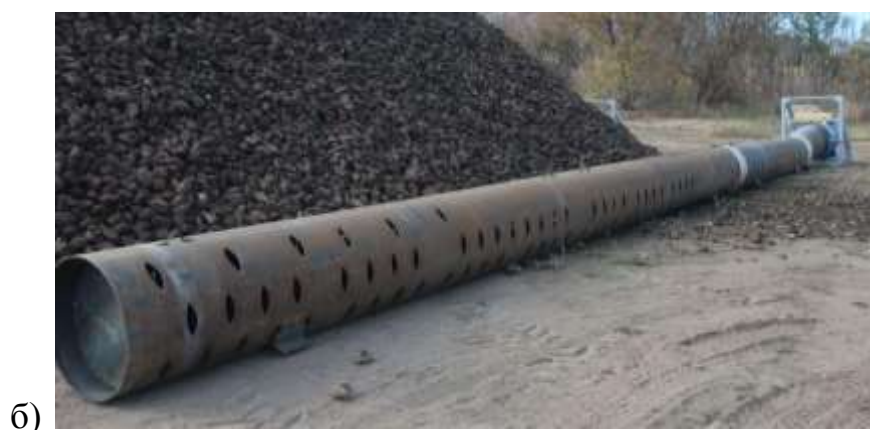
а – формирование кагата с помощью буртоукладочной машины; б – вентиляционная ветвь
