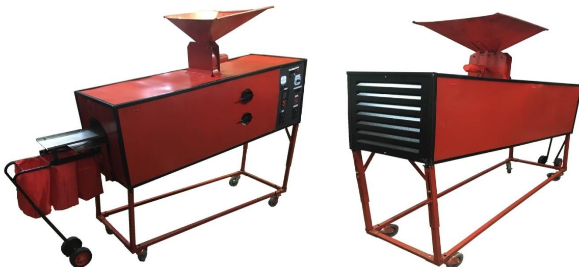
а) вид спереди; б) вид сзади Рисунок 16 – Внешний вид сепаратора ССБ-0,1
