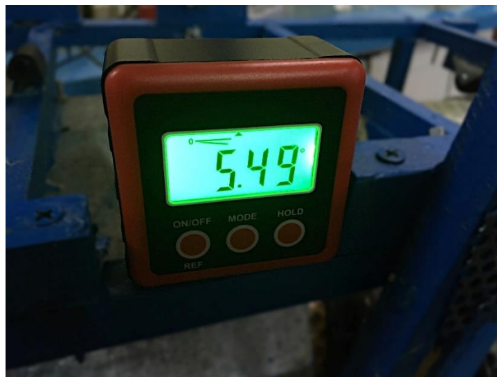
Рисунок 3.16 – Измерение наклона рабочего органа сепаратора
