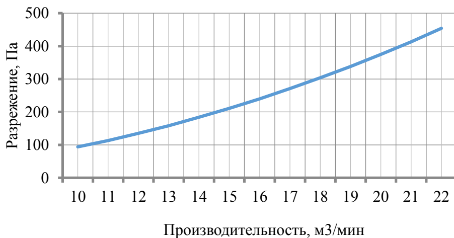
Рисунок 2.17 – Теоретическая зависимость разрежения на рабочей поверхности от производительности вентилятора
