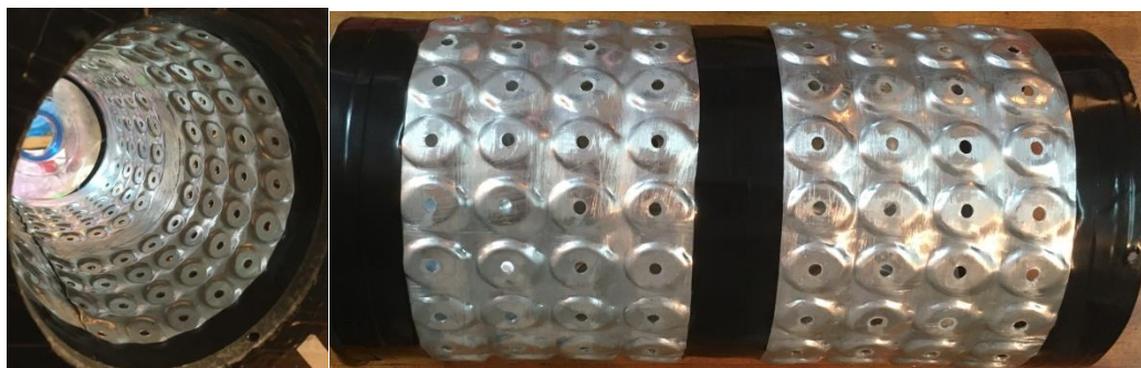
Рисунок 3.9 – Сепарирующая поверхность (решето с ячейками d = 4 мм, t = 20 мм)
