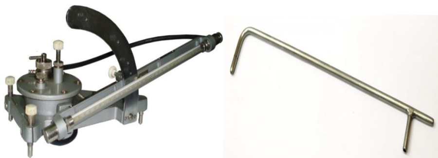
Рисунок К.2 – Микроманометр ММН-2400 с трубкой Пито
