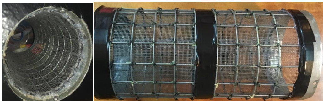
Рисунок 3.8 – Сетчатая сепарирующая поверхность ( a = 1 \times 1 мм)
