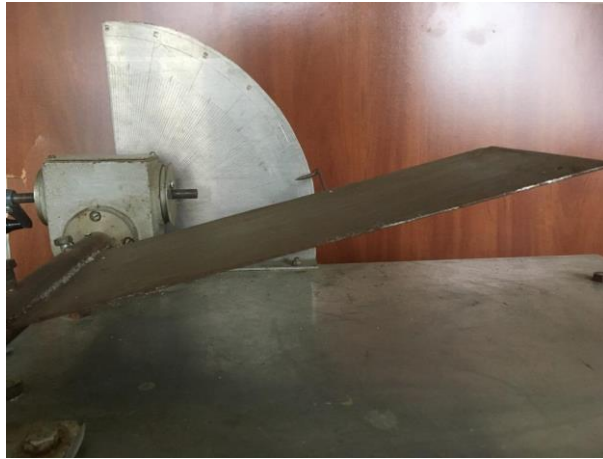
Рисунок 3.4 – Лабораторная установка «наклонная плоскость»
