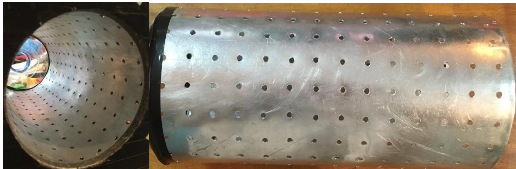
Рисунок 3.7 – Сепарирующая поверхность (ровное решето d = 4 мм, t = 20 мм)
