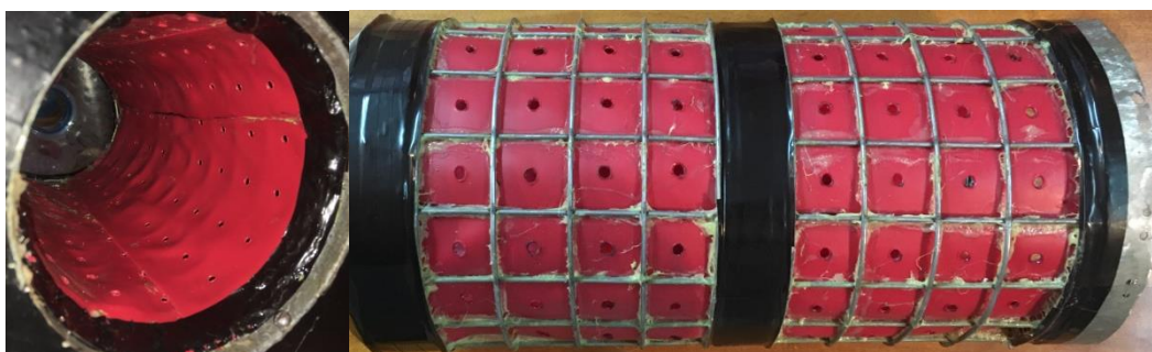
Рисунок 3.10 – Сепарирующая поверхность (резиновое решето с ячейками d = 4 мм, t = 20 мм)
