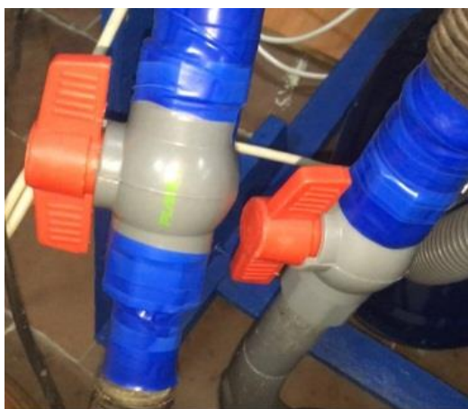
Рисунок 3.15 – Вентили для регулировки разрежения в воздушных камерах
