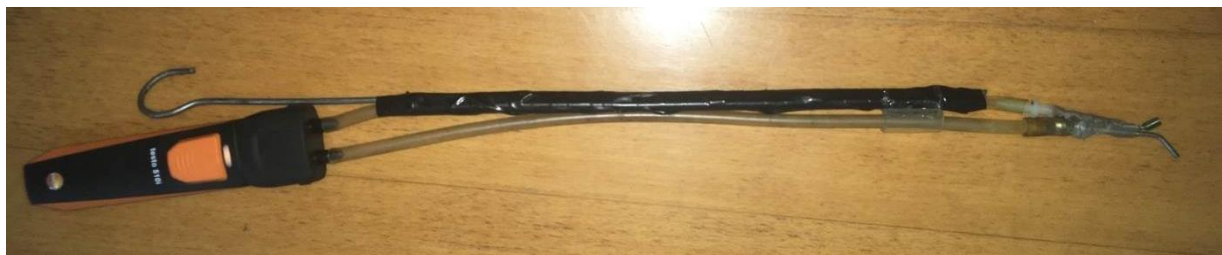
Рисунок 3.5 – Модернизированная трубка Пито Прандтля со смарт-зондом Testo 510i
